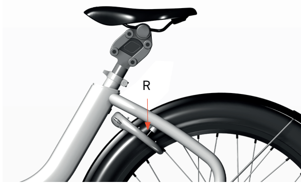
Image 35 : Vérification des caoutchoucs de verrouillage
