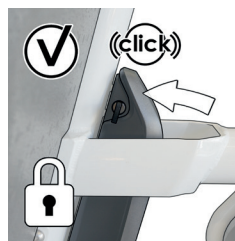
Abbildung 16 : Klickgeräusch signalisiert ordnungsgemäß eingesetzten Akku
