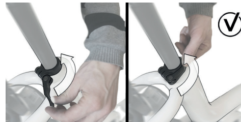
Abbildung 7 : Schließen des Schnellspanners der Sattelstütze
