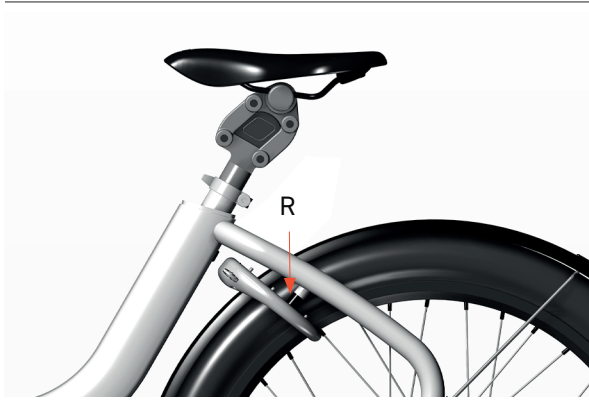
Afbeelding 35: De slotrubbers controleren
