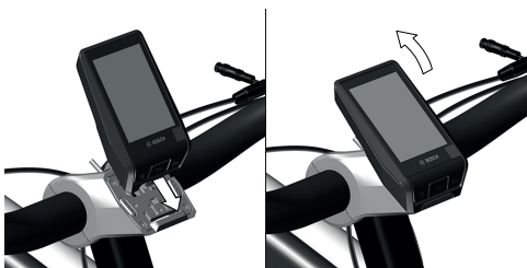
Abbildung 14 A: Einsetzen des Displays
