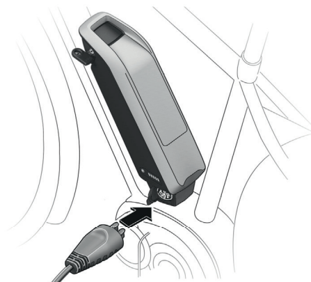
Image 28 : Branchement du chargeur dans la prise de charge sur la partie inférieure du support de batterie
