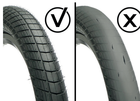
Image 31 : Usure des pneus
